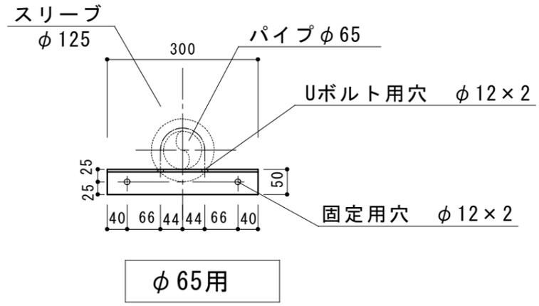
配管固定金物制作図 S=1/10
